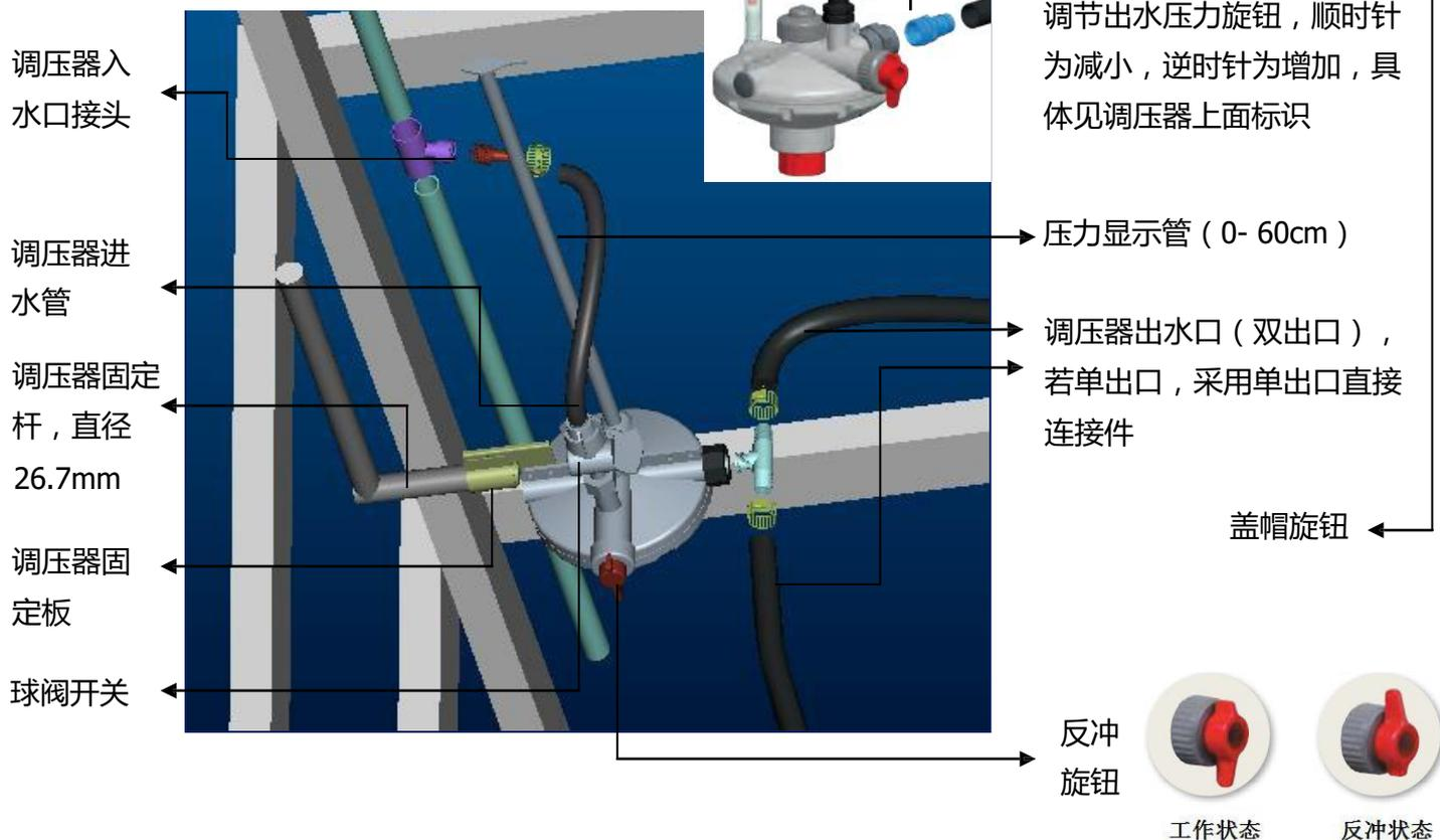
**注：**调压器使用一段时间后（具体时间根据客户的水质情况，在2个月-6个月之前），客户扭开盖帽旋钮，用清水把内部污垢或者脏污清洗干净，然后把旋钮安装到原来的位置。
